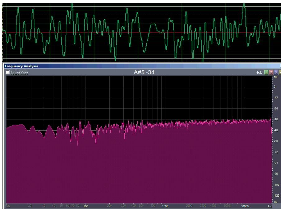
Obrázek 4.9: Časový průběh a frekvenční charakteristika vzorku bílého šumu
