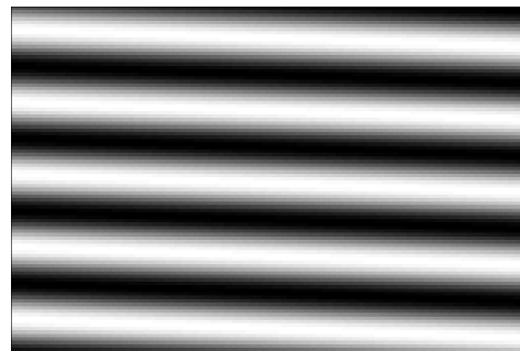
Obr. 3.2.2.11: Neporušený interferogram rekonstruovaný ze dvou vzájemně posunutých oblastí s lineární fází.
