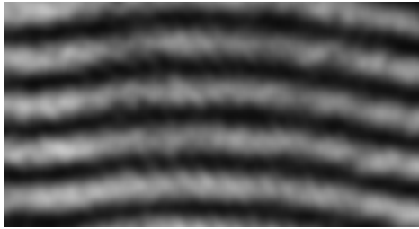
Obr. 3.2.2.16: Původní testovaný interferogram upravený Gaussovým filtrem.
