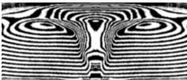
Obr. 6.3.5: Výsledný interferogram převedený zpět do odstínů šedi a rozostřený Gaussovým filtrem velikosti 3 \times 3 .
