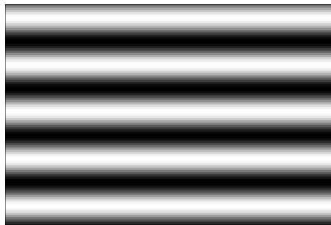
Obr. 3.2.2.10: Neporušený interferogram rekonstruovaný z jediné zvolené oblasti s lineární fází. (viz obr. 3.2.2.2)
