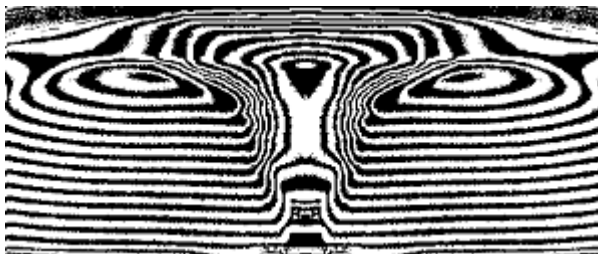
Obr. 6.3.4: Upravený výřez po zrekonstruování poškozených a zdvojených interferenčních čar.
