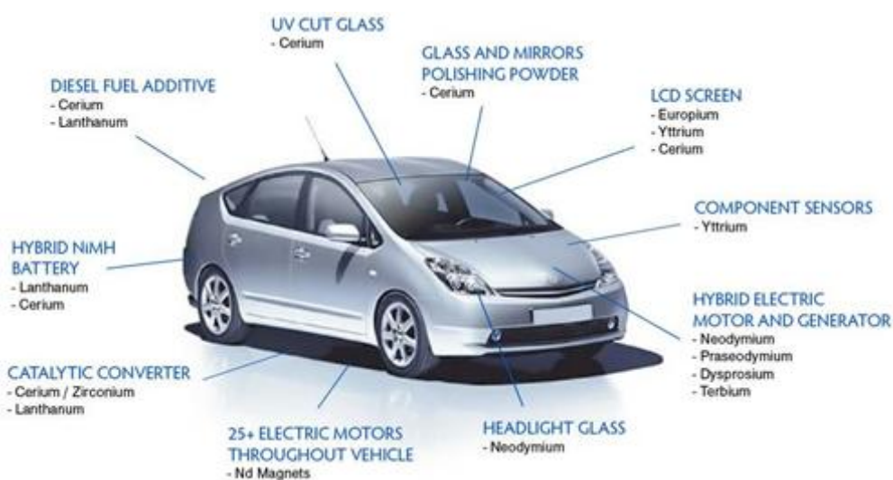
Obr. 6. Použití REE v hybridním elektrickém autě (převzato z Molycorp Inc., 2012 )
