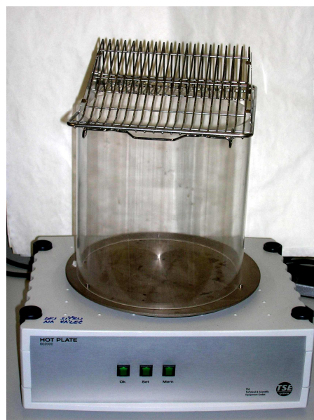
Obrázek 10. Test sedativních účinků v otevřeném poli a test analgesie na horké plotně
