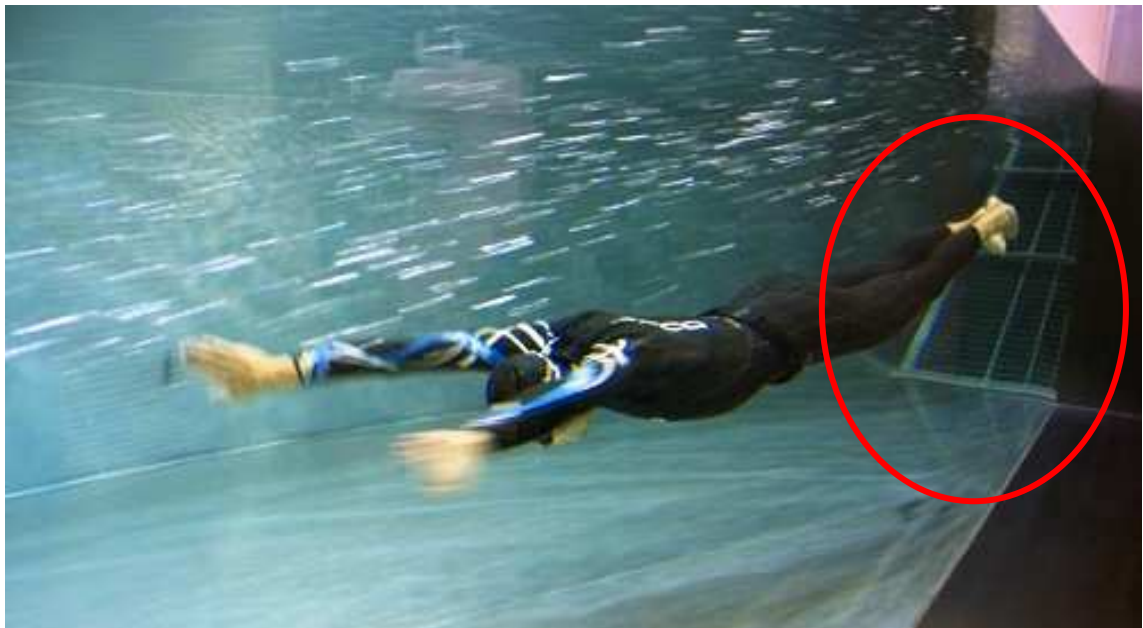
Obr. č. 2: Fotografie flumu v Tenerife Top Trainang Centre ( http://www.verticalblue.net/ ) s vyznačeným odsávacím kanálem
