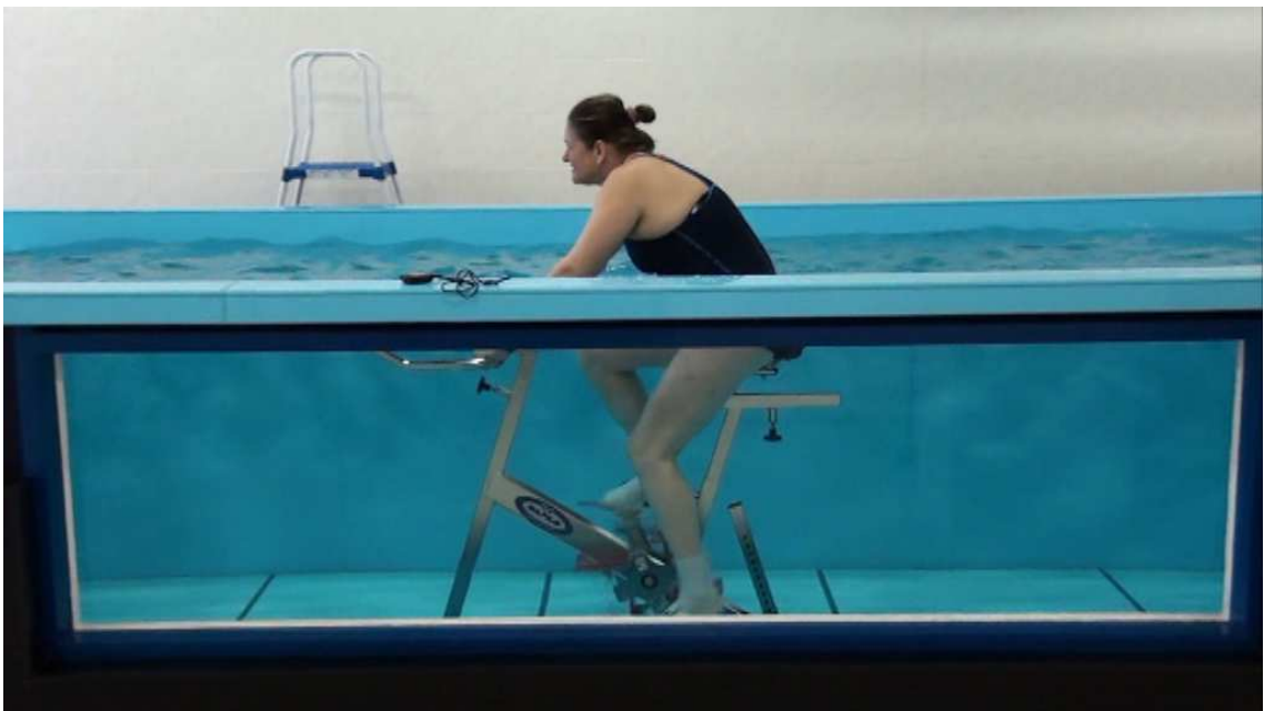
Obr. č. 10: Testování aqua spinningového kola ve flumu FTVS UK, foto: archiv Daniel Jurák
