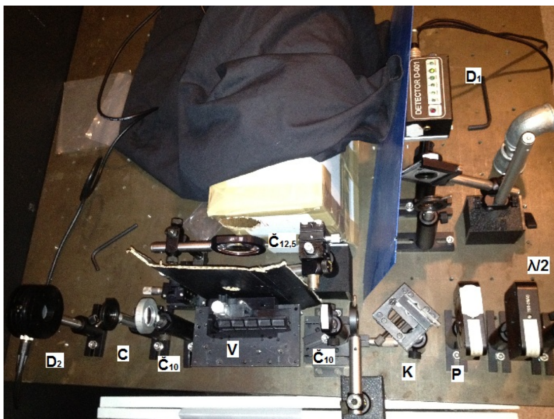
Obr. 2.2: Fotografie hlavní části použité aparatury; \lambda/2 půlvlnná destička, P polarizátor, K klínová destička, D detektory, \check{C}_\varphi čočky o optické mohutnosti \varphi , V vzorek, C clona
