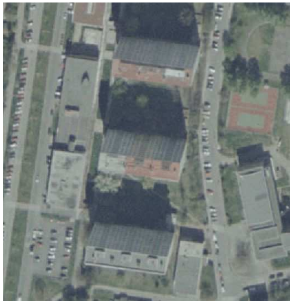
Obr 4.3 Radiální posun objektů (uklánějící se výškové budovy zakrývají sousední objekty)
