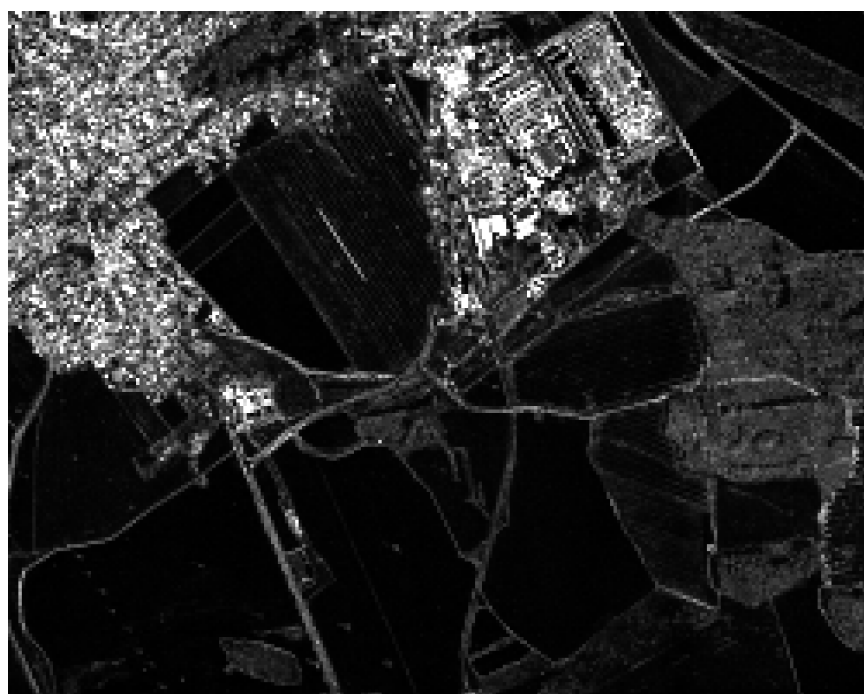
Obr. 5.4 GLCM kontrast pro segmenty 10x10 pixelů (světlé odstíny reprezentují vysoký kontrast značící velké rozdíly v hodnotách sousedních pixelů – intravilán, lesy)
