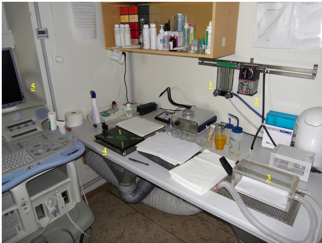
Obrázek č. 2. Echokardiografické pracoviště: rotametry (1); odpařovač (2); komora pro aplikaci inhalačního anestetika (3); vyhřívaná deska s pozlacenými elektrodami (4); echokardiografický přístroj (5) [Oddělení vývojové kardiologie, FgÚ AV ČR, Praha].
