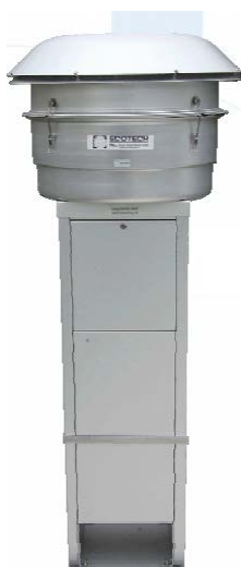
Obr. 9: High Volume Air vzorkovač s hlavicí nasávající aerosolové částice do velikosti 2,5 \mu\text{m} (Ecotech, Australia).
