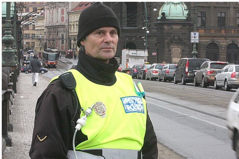
Obr. 8: Účastník personálního monitoringu s přístroji (k-PAU jsou vzorkovány přístrojem u pravé ruky účastníka, který je napojen na čerpadlo nasávající vzduch připojené k pasu; BTEX jsou vzorkovány pasivním přístrojem umístěným u levého ramene účastníka) (foto Ludvík Hradilek, Aktuálně.cz).
