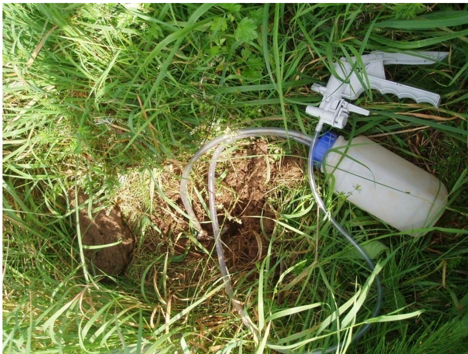
Obr. 5.2. – Odběr půdní vody z lyzimetru
