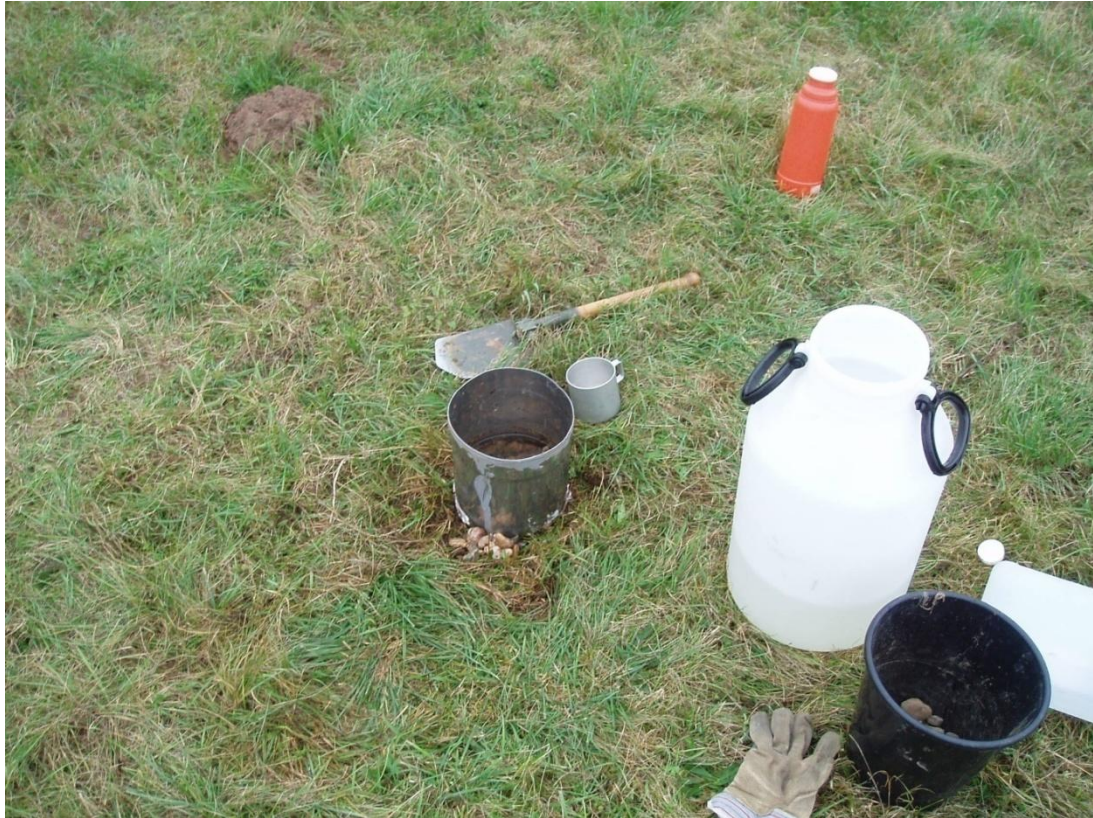
Obr. 5.3. – Infiltrační zkouška na povrchu travního krytu
