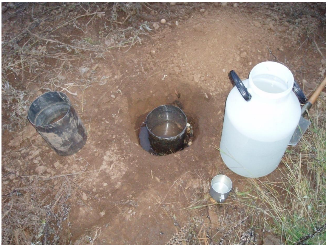
Obr. 5.4. – Infiltrační zkouška pod terénem na poli
