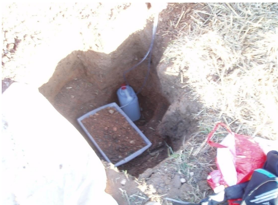
Obr. 5.1. - Instalace půdního lyzimetru
