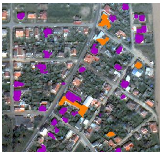
Obr. 43 Tmavé střechy – plech (oranžově)
