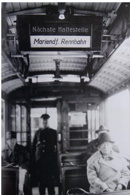
č. 10 První elektrický hlásič stanic v berlínské tramvaji, říjen 1928. Zdroj: METZGER Rainer a BRANDSTÄTTER Christian. Berlin Die Zwanzigjähre: Kunst und Kultur 1918 - 1933 . Christian Brandstätter Verlag. Wien 2006. S. 37.
