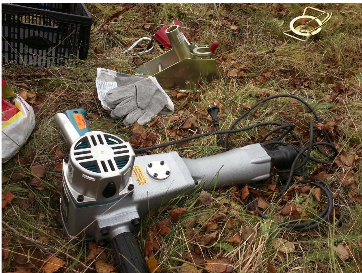
Obrázek 2: Vrtací zařízení pro odběr sedimentu
