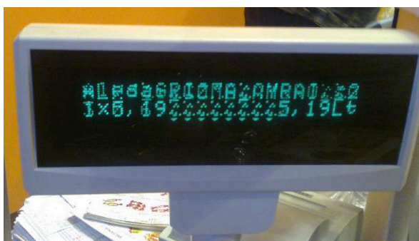
Obrázek 4.2: Glitch v displeji elektronické pokladny.
