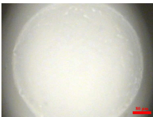
Obr. 3.9: Kvapka DOPC nakvapnutá na sklíčku s povlakom Sigmacote ®
