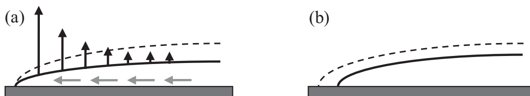
Obr. 1.9: Odparovanie kvapky s (a) pevným okrajom, (b) voľným okrajom
