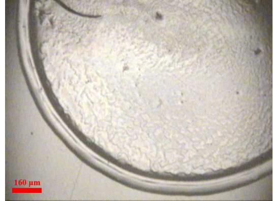
Obr. 3.5: Kvapka DPPC nakvapnutá na sklíčku CaF 2
