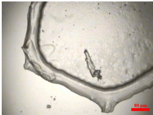
Obr. 3.6: Kvapka DPPC nakvapnutá na sklíčku s povlakom Sigmacote®
