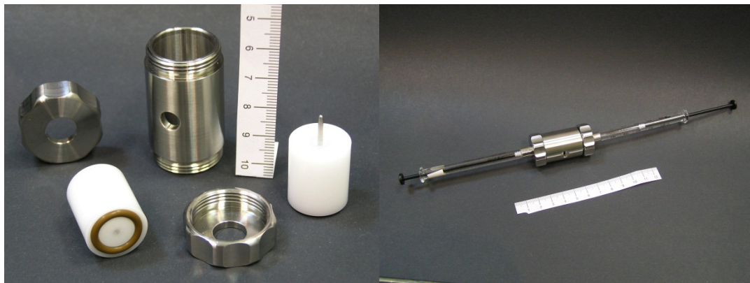
Obrázek 3. 2. – A) Jednotlivé části extrudéru (vlevo); B) extrudér složený do finální podoby a připravený k použití (obrázek vpravo)
