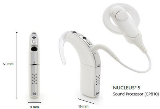
Obr. č. 10. Vnější část kochleárního implantátu Nucleus
