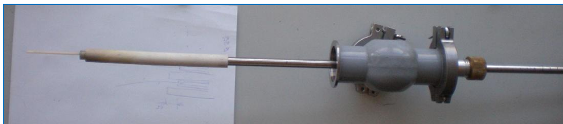
obr. č. 3.8 – sonda vynadaná z aparatury s nasazovací přechodovou koncovkou
