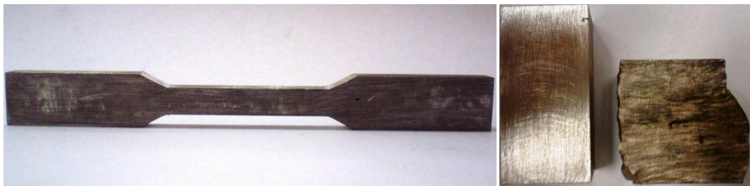
Obr. 2.1 tahový vzorek a tlakový vzorek před deformací a po ní
