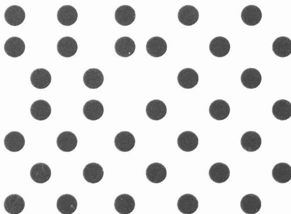
Obr. 5 - Antifázové domény (zobrazení roviny \{111\} ve struktuře B2).
