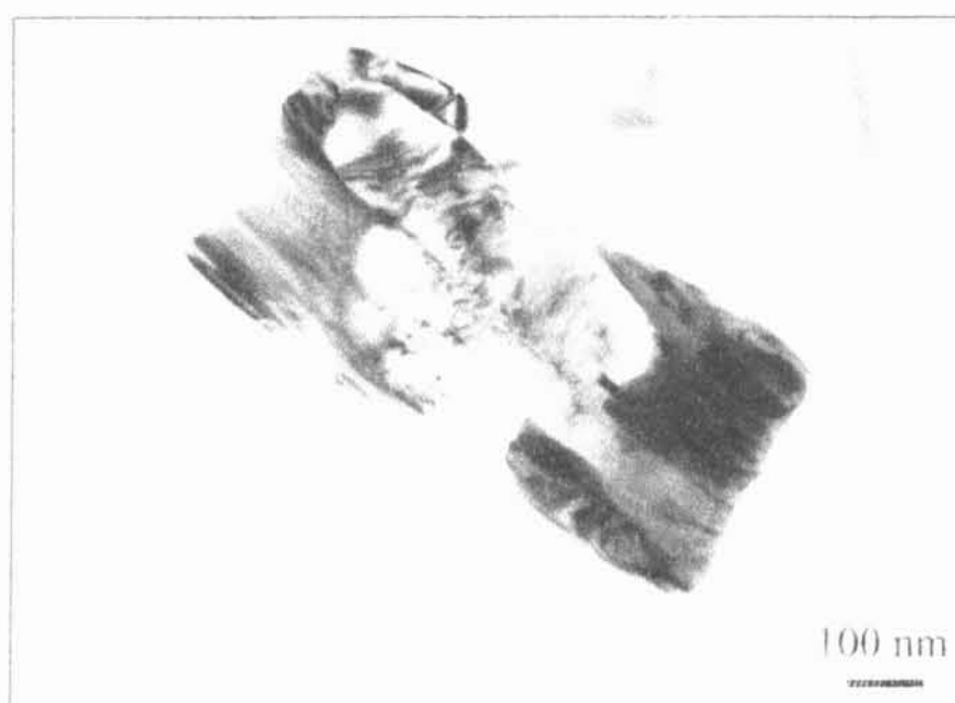
Obr. 29 – Částice TiB_2 ve vzorku I - B - \alpha 1150(1).
