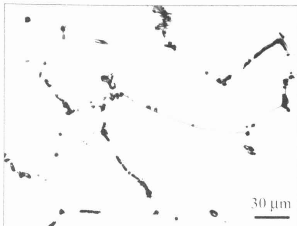
Obr. 76 – Částice na hranicích zrn v materiálu IV – A – 0.
