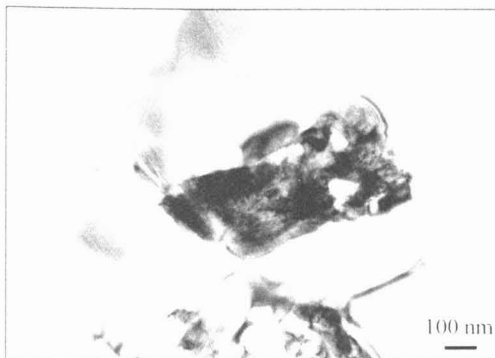
Obr. 82 - \text{TiB}_2 v materiálu IV – B – \alpha 700(1) .
