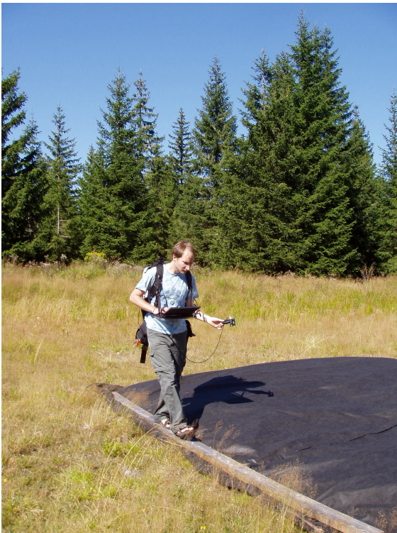
obr. 4: proměření reflektance kalibrační plochy pomocí pozemního spektrometru ASD FieldSpec-3 (vlevo) obr. 5: Microtops Sunphotometer II (vpravo)
