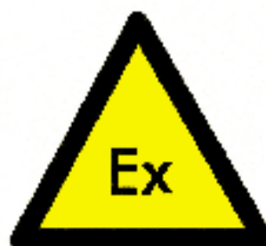
Nebezpečí – výbušné prostředí
