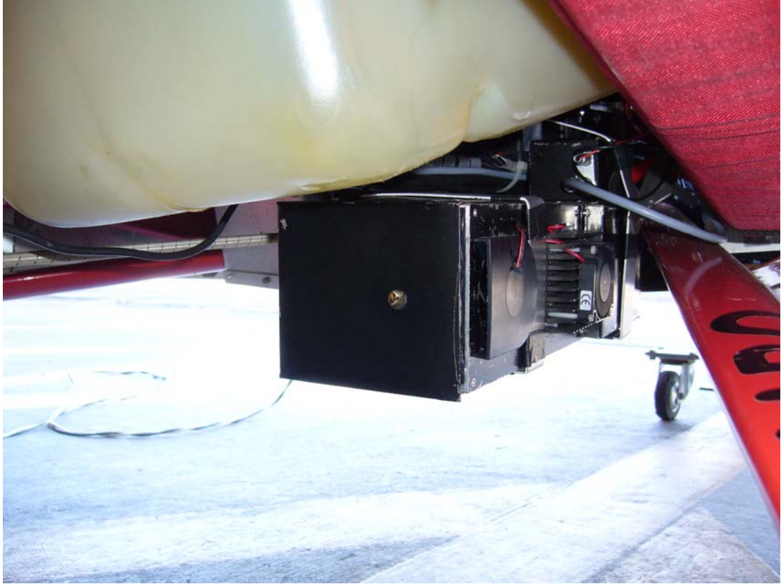
Obr. 10: Uchycení nephelometru na vzpěře pravého kola hlavního podvozku ultralehkého letounu IMK-MIFU.
