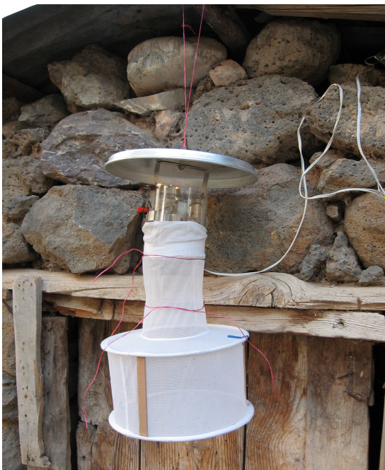
Obr. 3.2: CDC světelná past. Skládá se ze žárovky, vrtulky, akumulátoru, sítěky a stříšky proti dešti (foto Šeblová V.).
