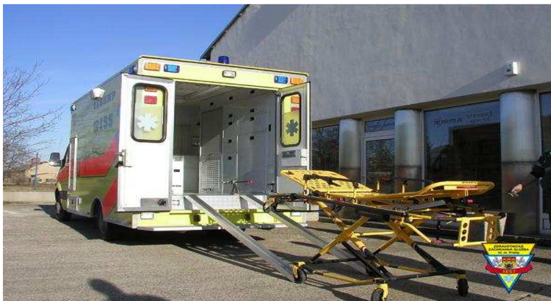
Obrázek 18 - Sanita "XXL" - speciální nosítka se zvýšenou nosností a speciální nájезд do sanitního prostoru
