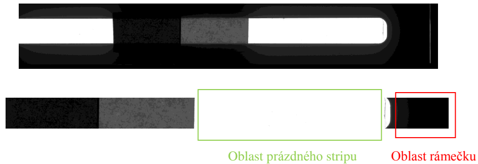
Obr. 28. Upravený kalibrační strip s přidaným černošedým pruhem papíru
