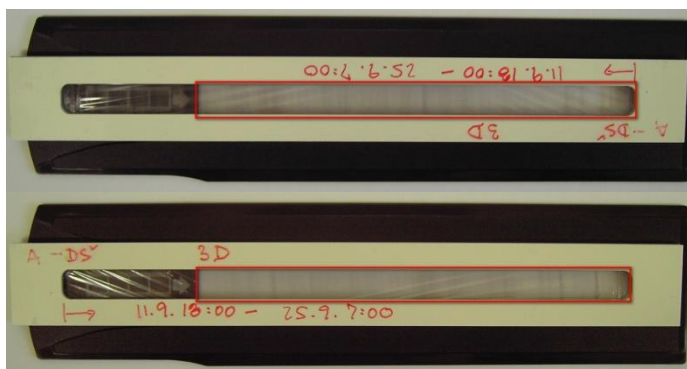
Obr. 16. Strip A z lokality Dobré Štěstí vložený do držáku tak, aby se snímala nejdříve jedna část stripu a pak druhá (v červeném rámečku jsou vyznačeny části stripu, které byly při skenování snímány)
