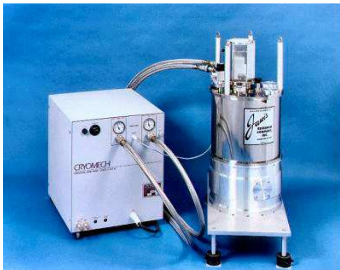
Obr. 22 Dvoustupňový magnetický refrigerátor s pulzní trubicí [17].
