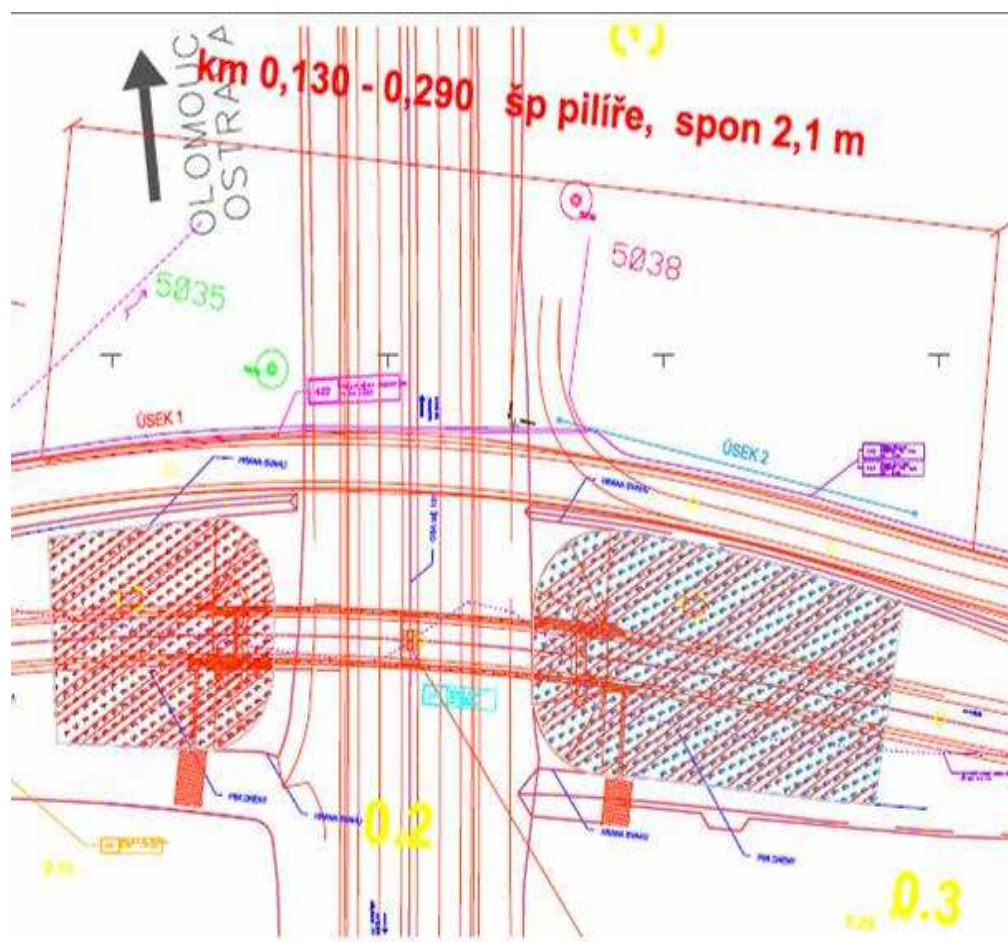
Obrázek 26: Přeložka místí komunikace – štěrkové pilíře pod vysokým náspem
