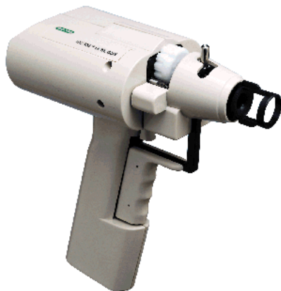
Obr. 2.6. Prístroj gene-gun používaný na intradermálnu imunizáciu s DNA vakcínami.
