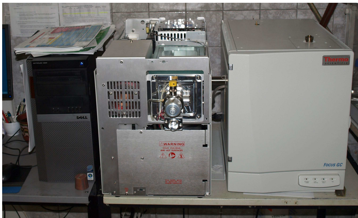
Obr.2.2.12: Plynový chromatograf s hmotnostně spektrometrickým detektorem.
