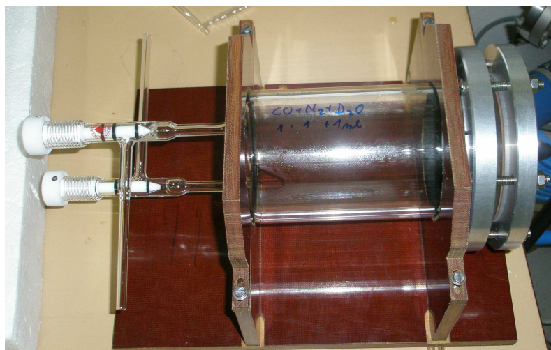
Obr. 2.3.2: Jedna ze dvou skleněných kyvet upevněná ve stojánku [74]
