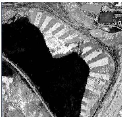
Obr. 17 Ukázka analýzy Linear Spectral Unmixing pro třídu lesů ve stáří nad 40 let (v obraze se jeví světlejší)
