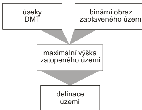
Obrázek 38: Vymezování zaplaveného území
