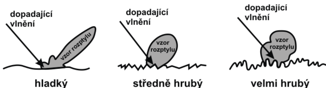
Obrázek 5: Vliv drsnosti povrchu na rozptyl (Canada Center for Remote Sensing, 2007)
