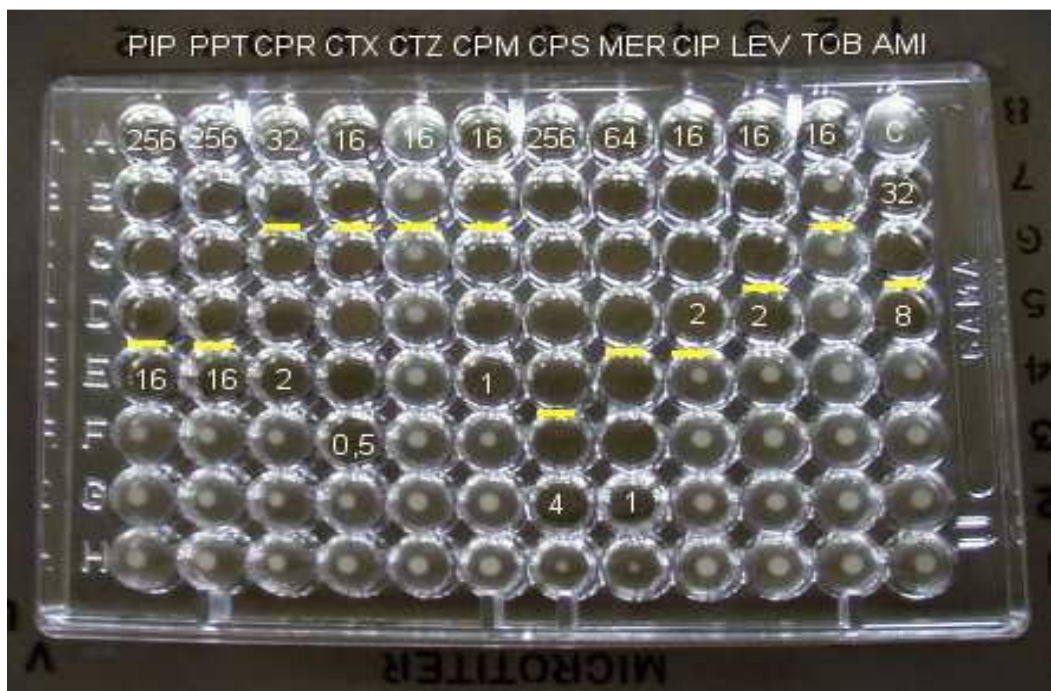
Obr. 6 Běžný mikrodiluční test (čísla: koncentrace atb, žlutě: break-point, inhibice růstu: bez zákalu), ( http://old.lf3.cuni.cz/mikrobiologie/bak/uceb/obsah/mic/zvets_pop.jpg )
