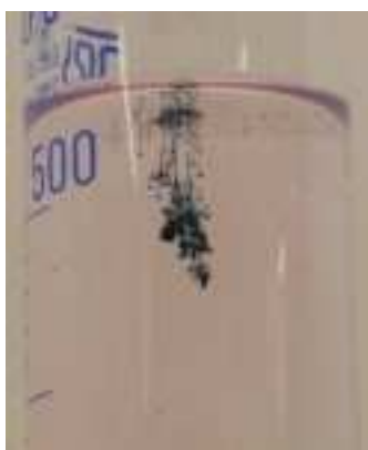
Obr. 6 c) První momenty po vhození produktu žhání do vody
