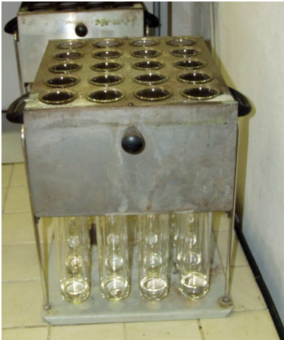
Obr. 3.2.2 Mineralizační trubice se spálenými vzorky připravenými k destilaci v přístroji Kjeltec 2200
