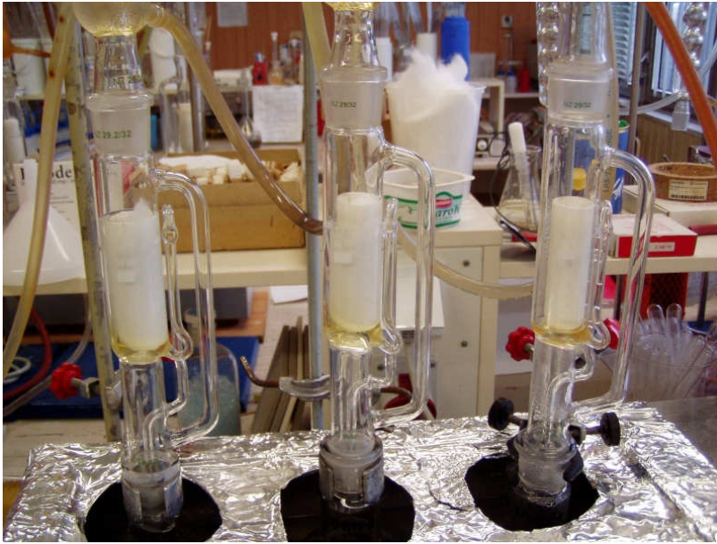
Obr. 3.2.1 Soxhletovy extraktory s vloženou extrakční patronou a částí vyextrahovaného tuku.
