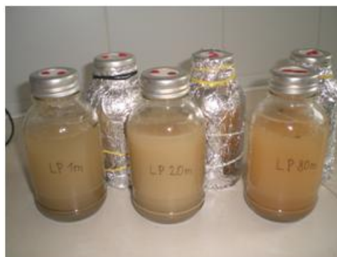
Obr. 8. Experiment na určenie vplyvu svetla (sklenené fľaše).
