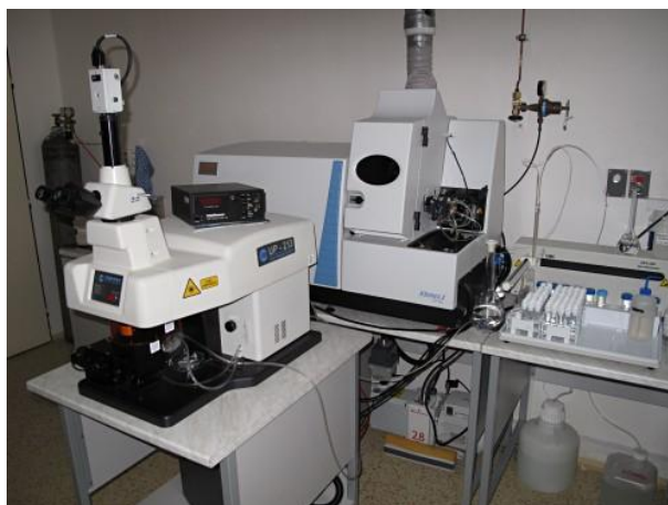
Obr. 32, NewWave 213nm – přístroj pro laserovou ablaci, spojení s hmotnostním spektrometrem s indukčně vázaným plazmatem - X-Series II; (19.4.2010); zdroj: http://web.natur.cuni.cz
