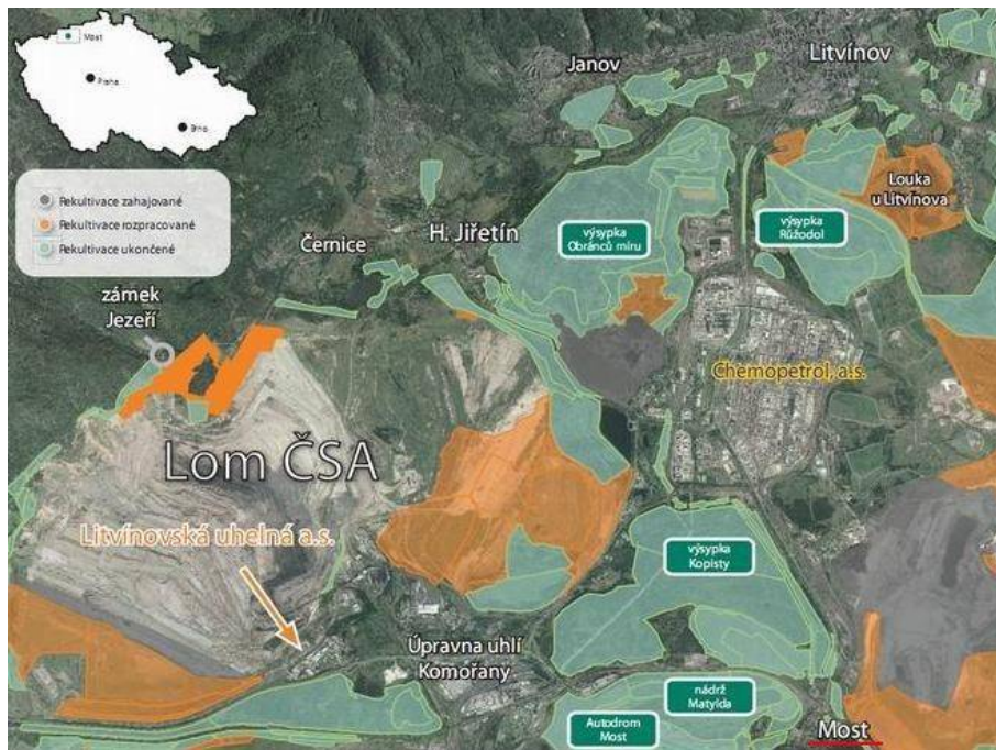
Příloha 3: Schematický plán dobýv. prostorů a rekultivaci SZ od Mostu (Czech Coal 2010).
