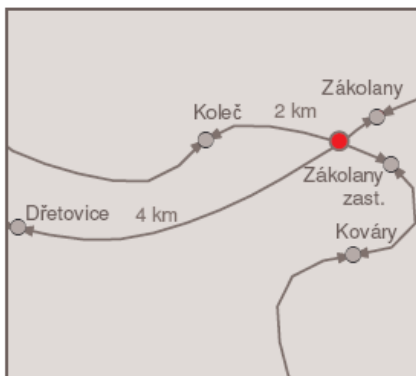
Obr. 9: Mimoúrovňové křížení (červeně vyznačen odstraněný uzel)
