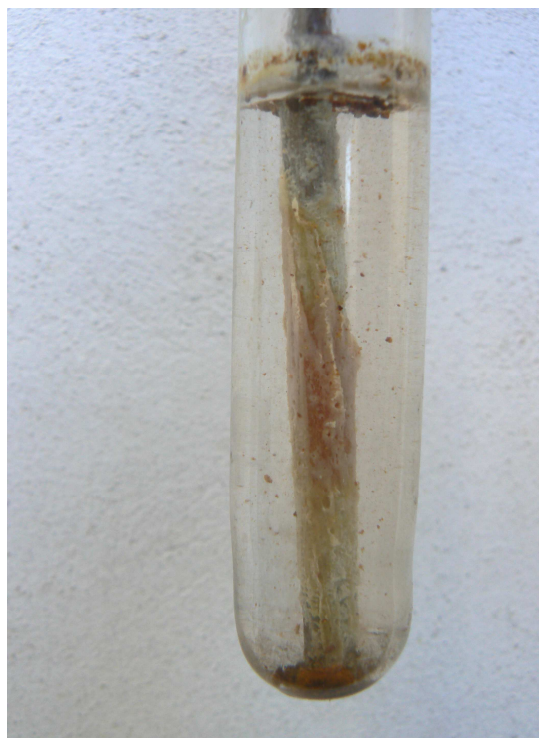
Obr. 35 Výsledný produkt reakce železného hřebíku pokrytého vrstvou vazelíny v Savu.
