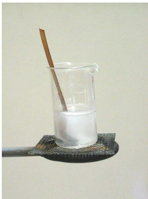
Obr. 30 Detail ponoření měděného plíšku ke granulím zinku při zahřívání.
