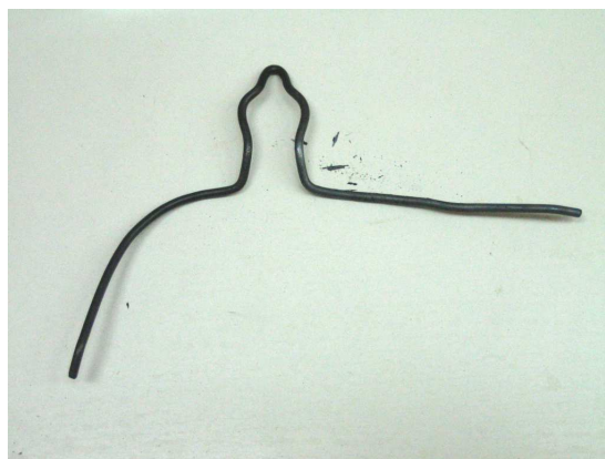
Obr. 25 Popuštěná ocel – potvrzení pružnosti a ohebnosti.
