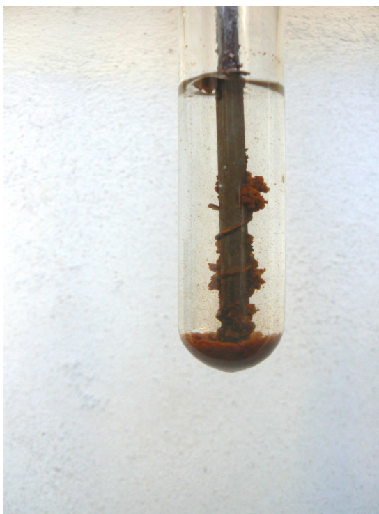
Obr. 33 Výsledný produkt reakce železného hřebíku omotaného měděným drátem v Savu.
