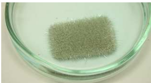
Obr. 18 Výsledný produkt reakce zinkového plechu v roztoku dusičnanu stříbrného [42].
