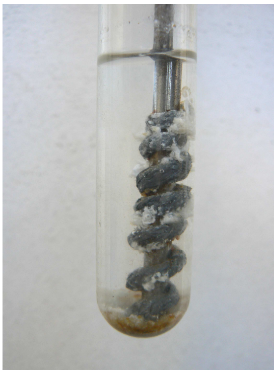
Obr. 34 Výsledný produkt reakce železného hřebíku omotaného alobalem v Savu.
