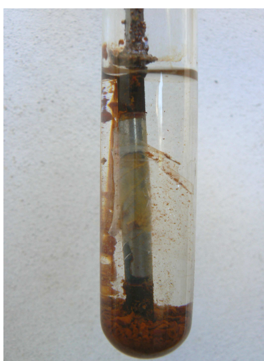
Obr. 36 Výsledný produkt reakce železného hřebíku krytého lepenkou v Savu.
