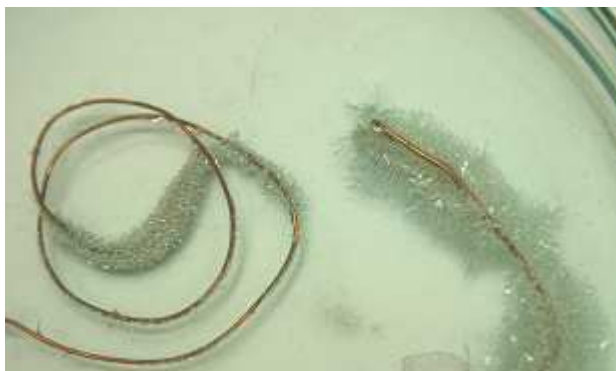
Obr. 17 Výsledný produkt reakce měděného drátu v roztoku dusičnanu stříbrného [42].
