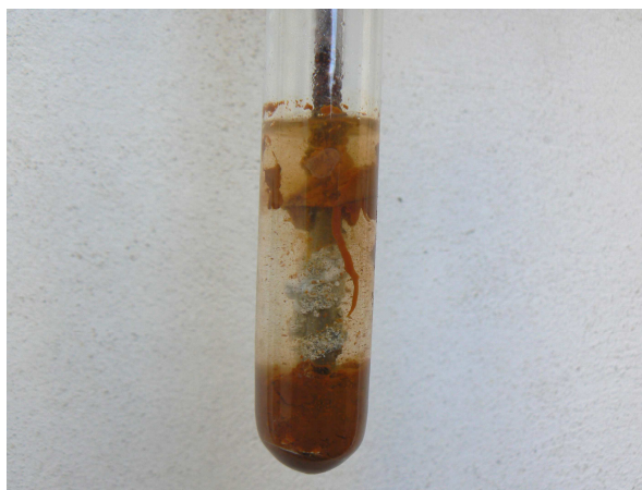
Obr. 38 Výsledný produkt reakce železného hřebíku omotaného zinkovým plískem v Savu.
