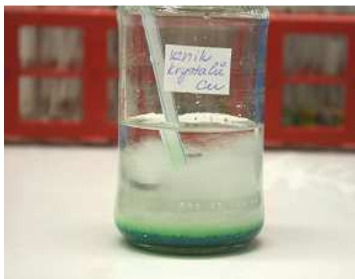
Obr. 20 Zahájení experimentu reakce železného drátu se síranem měďnatým [42].
