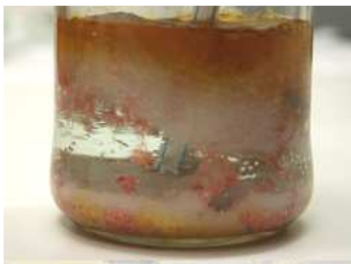
Obr. 21 Průběh experimentu reakce železného drátu se síranem měďnatým za vzniku mědi [42].
