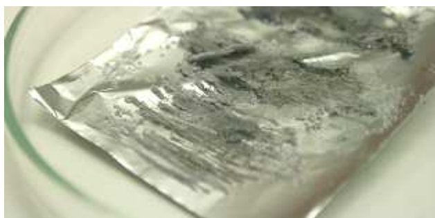
Obr. 19 Výsledný produkt reakce alobalu s chloridem rtuťnatým [42].
