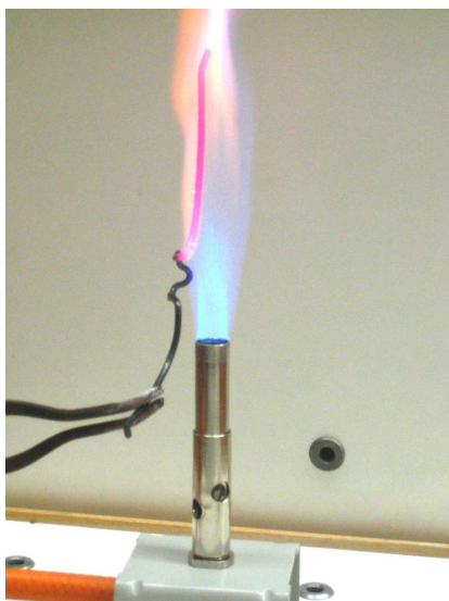
Obr. 26 Zahřívání ocelového drátu při kalení.
