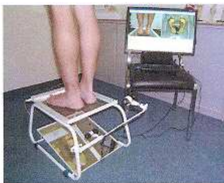
Obr. č. 14 - PodoCam: umožňuje snímání nohy zezadu a plosky zesponu, statický i dynamický záznam (15)
