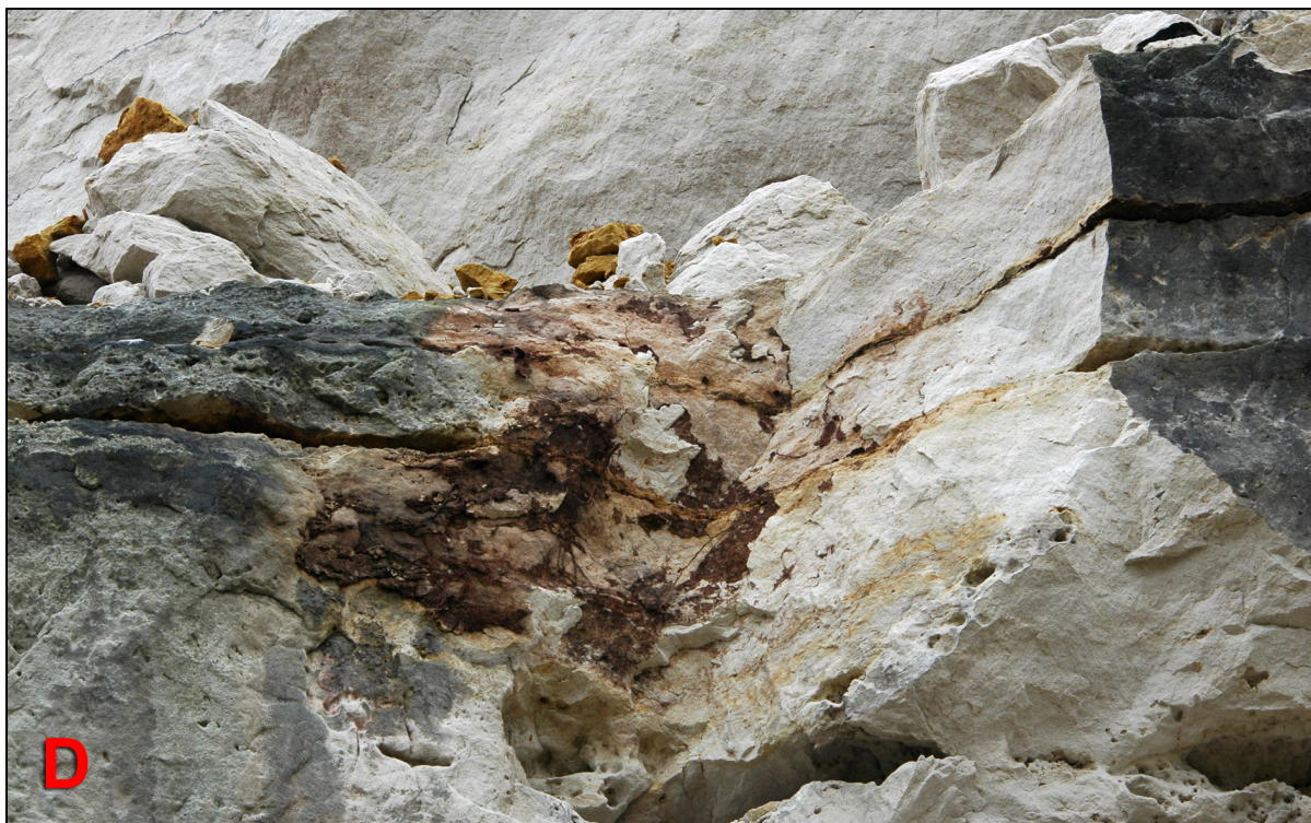
Foto 7 – Detail odlučné plochy. Stopy po kořenovém systému vegetace a zvětrávání uvnitř pukliny.
