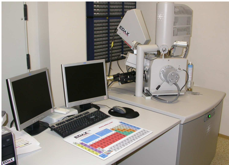
Obrázek 2.1: Řádkovací elektronový mikroskop FEI Quanta 200F se systémem EDAX Trident (EDS detektor je vidět nalevo od hlavního tubusu v horní části) a EBSD systémem EDAX-TSL s kamerou DigiView II (kamera má černou barvu a je vidět nalevo od komory se vzorkem). Nad kamerou EBSD je infra kamera, která umožňuje bezpečnou manipulaci se vzorkem v komoře (vizuální kontrola při naklápění a posunování vzorku).
