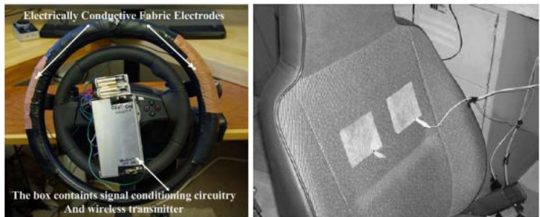
Obr. 7 Vlevo – elektrody na volantu, vpravo – elektrody na sedadle řidiče
