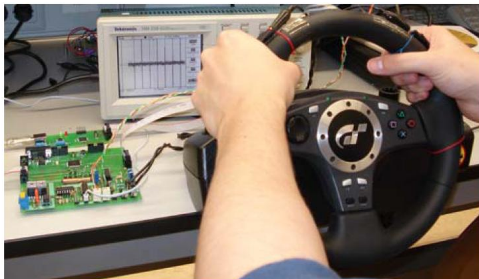
Obr. 5 Hardwarové vybavení systému pro detekci EKG signálu a síly úchopu volantu (8).
