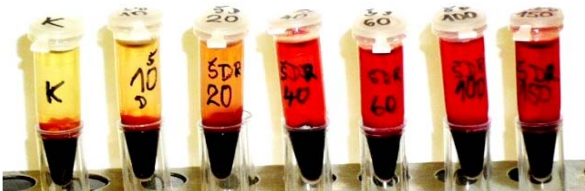
Obr. 17 Fotodokumentace z experimentu – viditelná stoupající barevná řada, jako důsledek zvyšující se koncentrace volného hemoglobinu v plazmě
