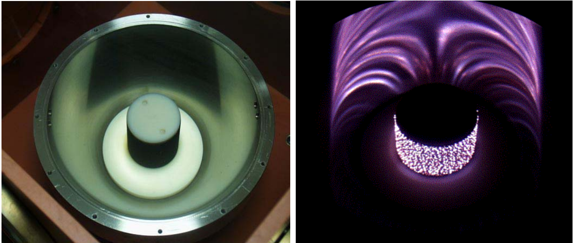
Obr. 11 Experimentální generátor před výbojem (vlevo) v čase výboje (vpravo).
