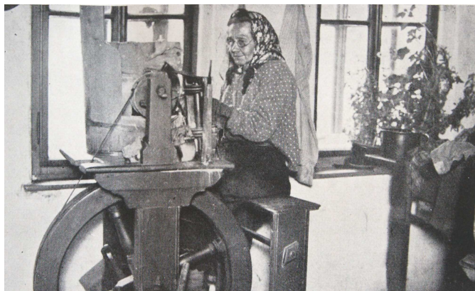
Obrázek 1: Domácké broušení perel za pomoci šlapacího brusu, tzv. klemprdy.
