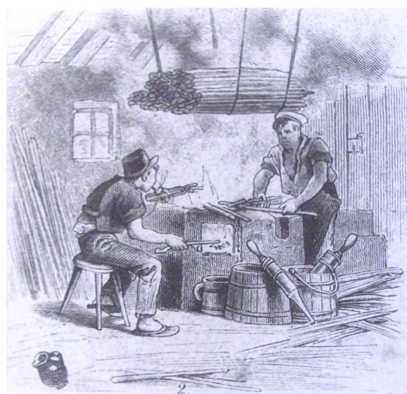
Obrázek 2: Práce domácích mačkářů u pece, kde se tavily skleněné tyče.
