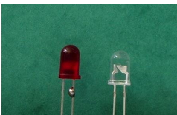
Obrázek 4-B Zástupci difúzního a čirého provedení těla LED diody (vedeny zleva doprava) o průměru 5mm.
