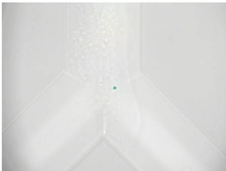
Obr. 3.2. Mikrosnímek soutoku, na kterém je v pravé části (díky rozdílnému indexu lomu, přítomnosti mikrobublinek a způsobu osvětlení) viditelné posunuté rozhraní mezi oběma vzorky.
