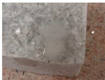
Obr. 17. Reakce mramoru s 10% kyselinou chlorovodíkovou.
