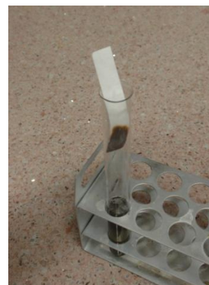
Obr. 12. Důkaz unikajícího sulfanu pomocí filtračního papírku namočeného do roztoku dusičnanu olovnatého.
