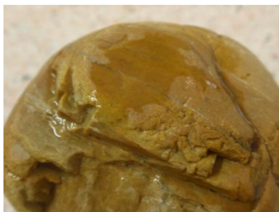
Obr. 18. Křemenec po nakapání 10% kyseliny chlorovodíkové.
