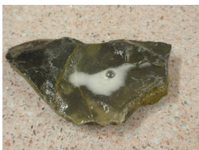
Obr. 16. Reakce vápence s 10% kyselinou chlorovodíkovou.
