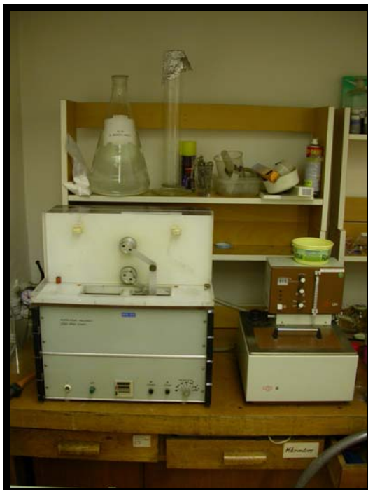
Obr. 37: Termocyklační přístroj (Fotografie pořízená v laboratoři VÚS v Praze, kde byla realizována experimentální část studie)
