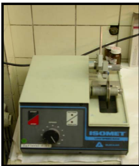
Obr. 38: Isomet – bruska s diamantovým kotoučem (Fotografie pořízená v laboratoři VÚS v Praze, kde byla realizována experimentální část studie)
